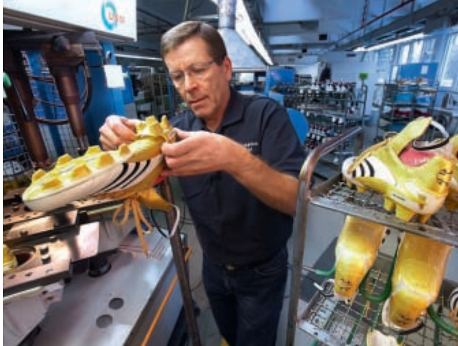
Schuhkörper, Sohle und Fersenteil werden in einer Wärmekammer auf Klebetemperatur gebracht, bevor sie auf einem Leisten vereinigt werden
