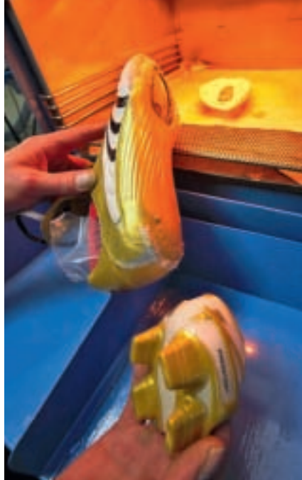
Schuhkörper, Sohle und Fersenteil werden in einer Wärmekammer auf Klebetemperatur gebracht, bevor sie auf einem Leisten vereinigt werden
