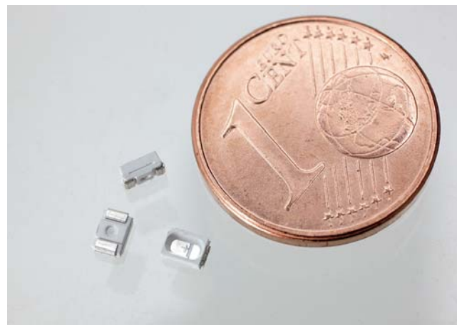
Größenvergleich: Mit Reflektorsockeln basierend auf VESTAMID® HT plus lassen sich auch kleinste LED's herstellen.
